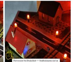
Der **Photosensor** oben schaltet die Straßenbeleuchtung bei Dunkelheit ein und bei Helligkeit wieder aus.
